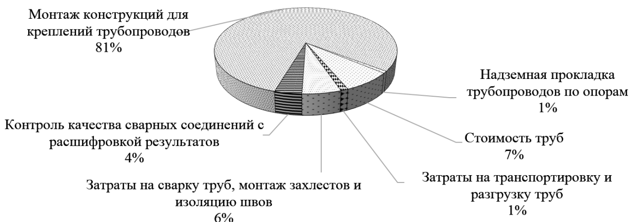
Рис. 4 – Структура затрат на строительство стального трубопровода 16
