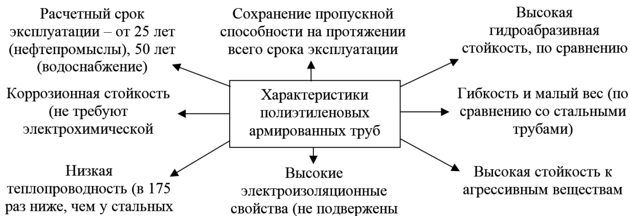
Рис. 3 – Технологические преимущества полимерных армированных труб 14
