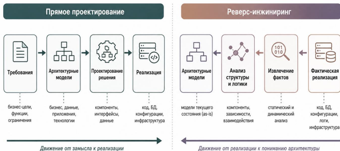
Рис. 2 – Логика получения архитектурных моделей при прямом проектировании и реверс-инжиниринге информационной системы
